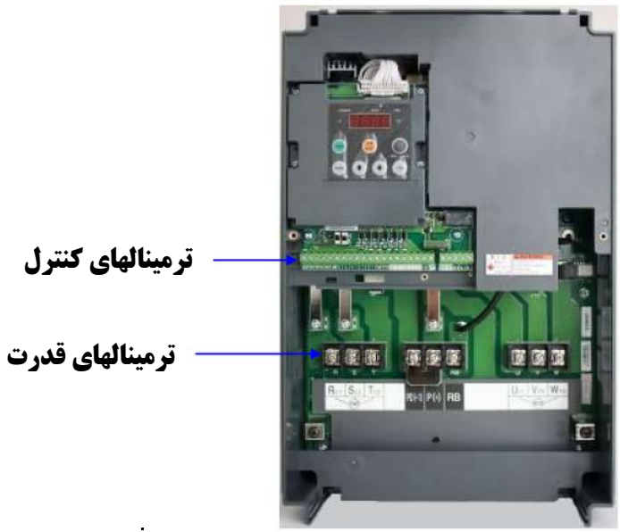
نمای مقابل اینورتر بعد از حذف پوشش اصلی
